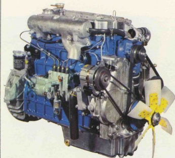
Moteur, Unic, Diesel 4 cylindres Injection directe
